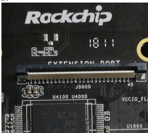
图3-17 50PIN连接座
