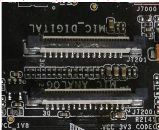
图3-16 麦克风阵列子板连接座
