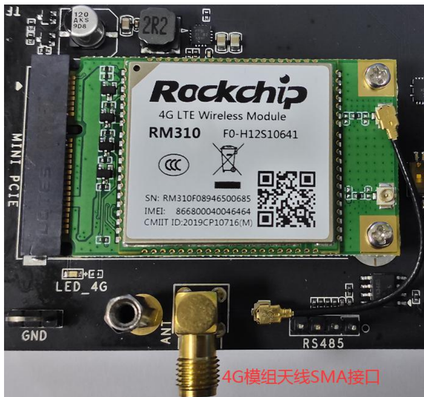
Figure 3-33 4G 模组与 SMA 天线接口
