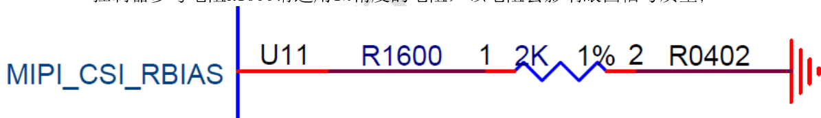
图 3-51 PX30 MIPI-CSI控制器参考电阻
