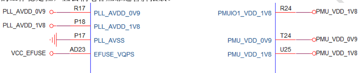
图 3 - 10 RK3399 芯片PLL电源1
