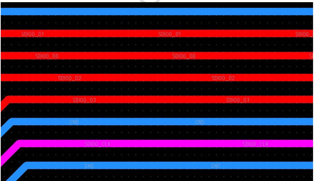
图 4 - 42 SDIO/SDMMC 走线隔离
