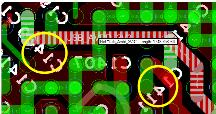
图 4-59 电源去耦电容放置
