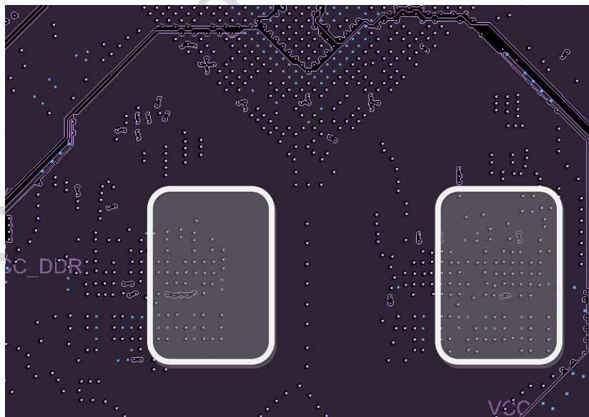
图 4-58 DDR下方的完整参考面
