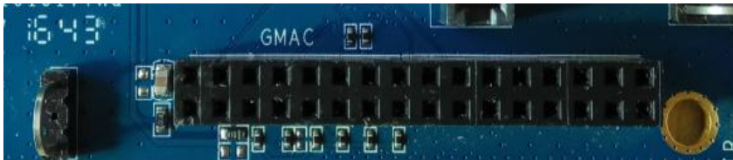
图 3 - 31 BOX开发板以太网外置10/100/1000M PHY输出
