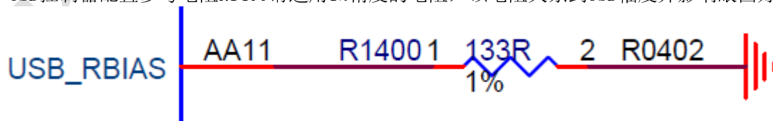
图 3-28 RK3358J USB控制器参考电阻
