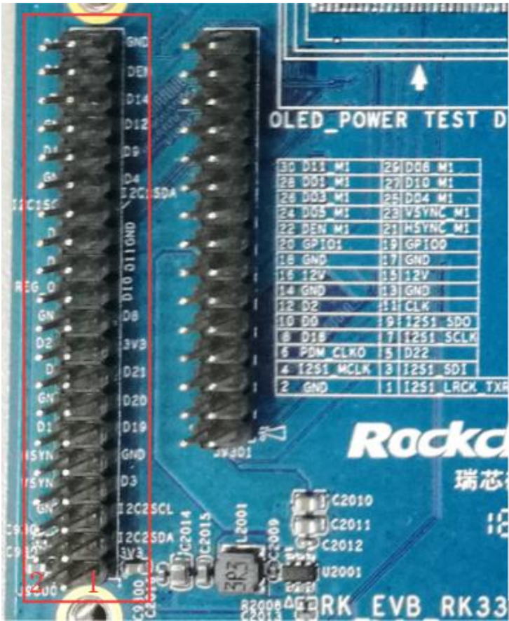
图 3-21 EVB Raspberry Pi接口
