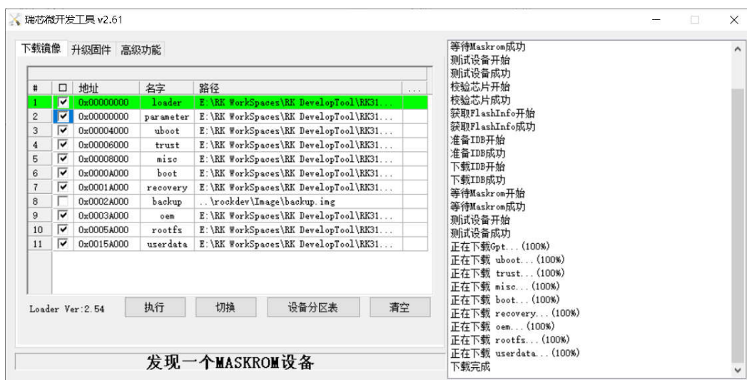
图 1-7 进入 MASKROM 烧写模式示意图
