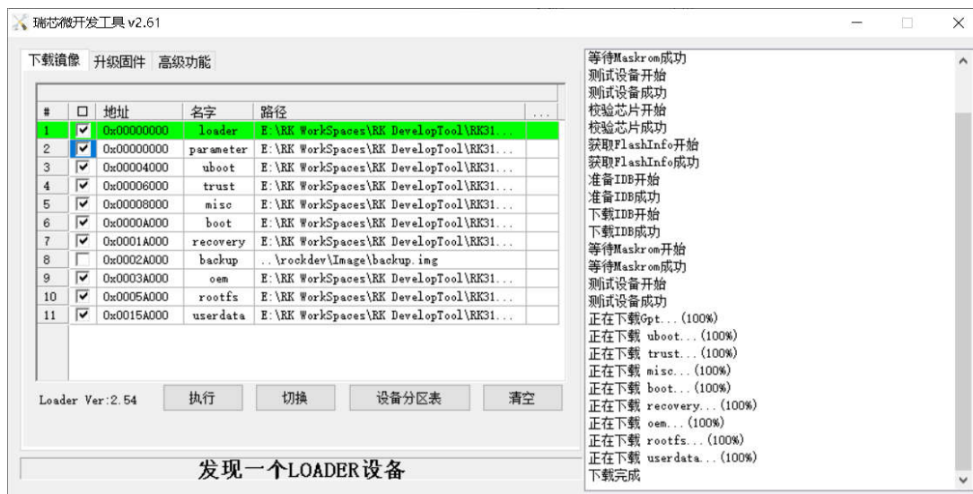
图 1-6 进入 Loader 烧写模式示意图
