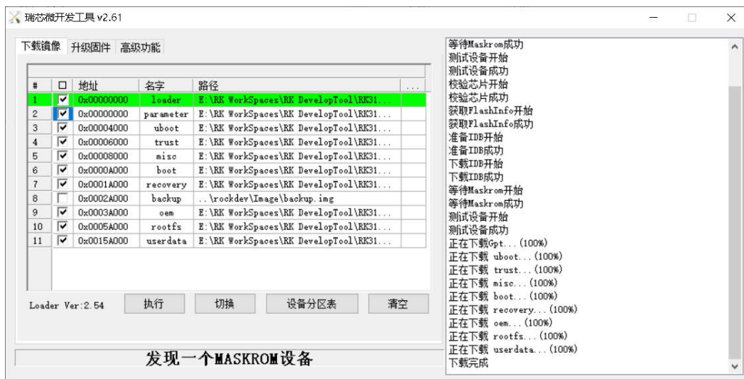
图 1-7 进入 MASKROM 烧写模式示意图
