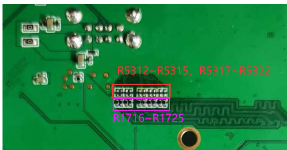
图 3-12 RGB/MCU Panel 与 MIPI DSI/LVD TX 接口电阻跳选示意
