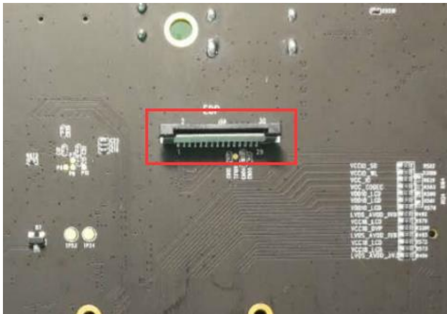
图 3-10 eDP 连接座位置和实物图
